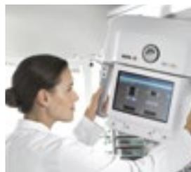
**SmartAlign** verwendet hochmoderne Sensorik und überprüft damit, ob Röhre und DR-Detektor optimal zueinander ausgerichtet sind, speziell auch bei Betaufnahmen, und zeigt dem Anwender, wenn die Positionierung angepasst werden sollte.
