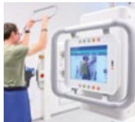
**SmartPositioning** ergänzt das LiveVision-Kamerabild mit einer virtuellen Projektion des eingestellten Kollimationsfeldes (Overlay) auf den Körper des Patienten. Das daraus resultierende Augmented Reality-Bild zeigt zusätzlich die Position der aktiven Belichtungskammern des Systems.
